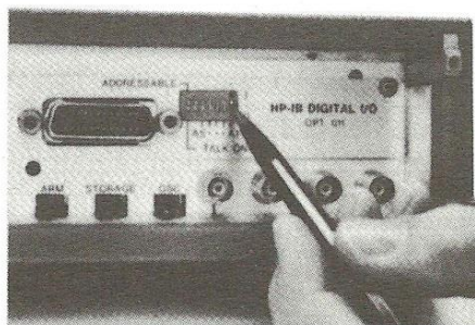
Figura 8.3 Direccionamiento de un instrumento controlable con el bus IEEE-488. (Cortesía de Hewlett-Packard Española S.A.)
